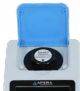
Abdeckung des Probenschachts
